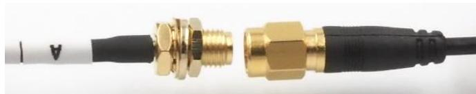
3.通信用アンテナ（4G回線）側のコネクタを約8～10回ほど時計回り（右回り）で回し、しっかりと締める。
