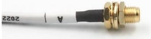
2.本体① タグAと、通信用アンテナ（4G回線）のコネクタを合わせて、水平に差し込む。
