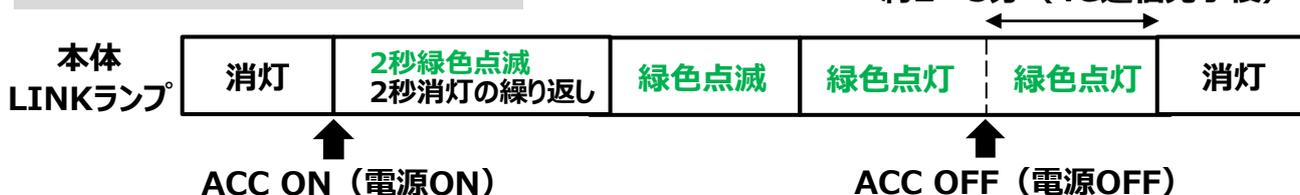
※ACC OFF後、4G通信NGの場合、ACC OFF後約16秒後に強制的にシャットダウンします。
