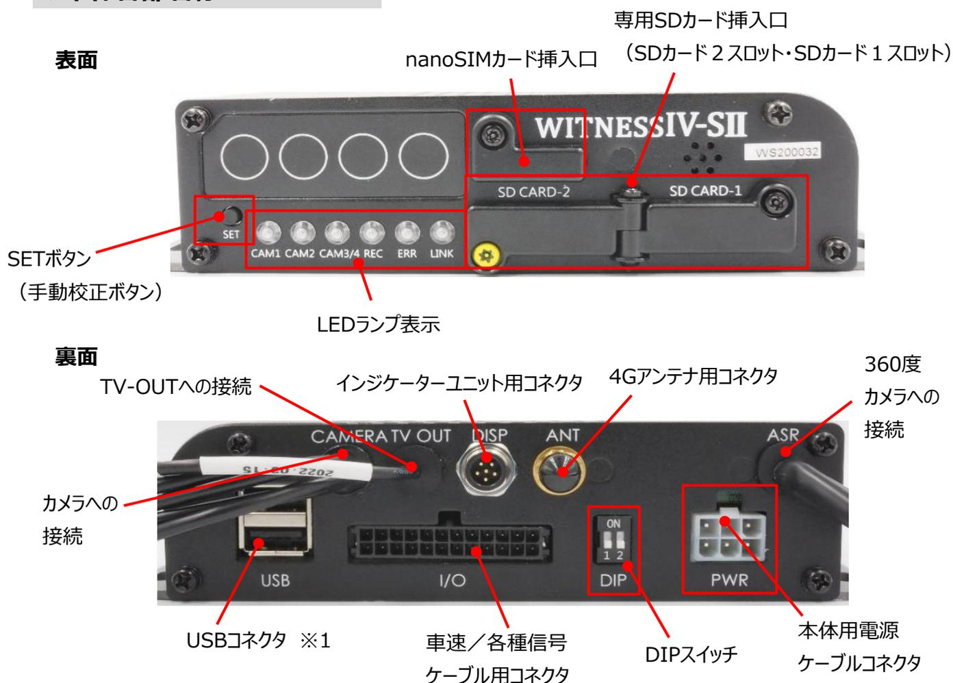
※1 本体のUSBコネクタ（差込口）は、本体と連動するオプション機器専用のものとなります。スマートフォンの充電等、オプション機器以外の機器を接続、使用されますと、本体の録画機能が正常に動作しなくなる恐れがあるため、オプション機器以外は接続しないでください。
