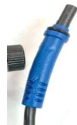
※防水カメラ用ケーブルおよびコネクタ・コネクタカバー部分は高温対応（85℃）となっています。ただし、この温度は室温が基準のため、高温の金属などに触れた場合は燃えませんが溶解します。溶解時、またはその後冷めて固まるなどした場合、コネクタ・コネクタカバー部分が変形・破損などしてご使用できなくなる可能性があります。高温になる金属には触れないよう、配線・接続・設置を行ってください。
