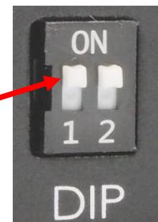
※無電圧車速パルス車でない車両で、DIP（ディップ）スイッチをONにすると、メーターが破損する
