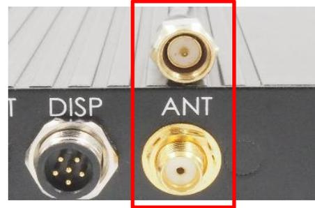
3. 通信用アンテナ（4G回線）側のコネクタを約8～10回ほど時計回り（右回り）で回し、しっかりと締める。
