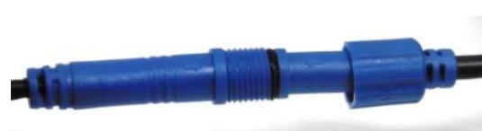
4. カメラ用ケーブルと、カメラから出ているコネクタの矢印を合わせて水平に差し込む。
