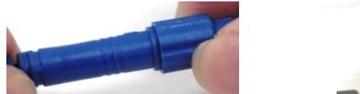
※しっかりと接続されていない、また、コネクタ部分に圧等（右写真）がかかる取付は、車の振動などで接触不良が起こり、カメラエラーや取得映像にチラつきなどが出る場合がありますのでご注意ください。カメラエラーやチラつきが出た場合は、再度コネクタ部分を外し、再接続を行ってください。
