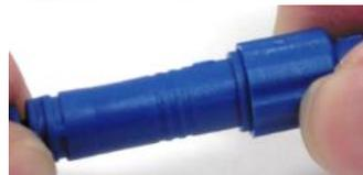
※しっかりと接続されていない、また、コネクタ部分に圧等（右写真）がかかる取付は、車の振動などで接触不良が起こり、カメラエラーや取得映像にチラつきなどが出る場合がありますのでご注意ください。カメラエラーやチラつきが出た場合は、再度コネクタ部分を外し、再接続を行ってください。
