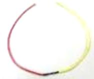
※無電圧車速パルス車でない車両にプルアップハーネスを取り付けると、メーターが破損する
